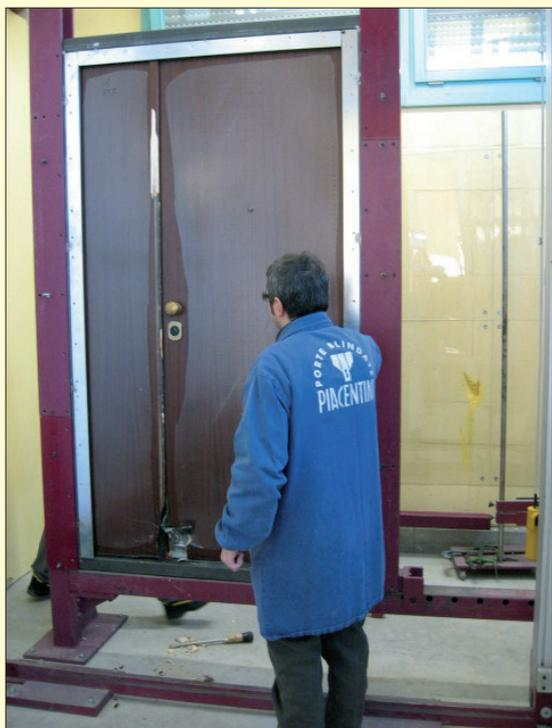
Antieffrazione: prova attacco manuale.
