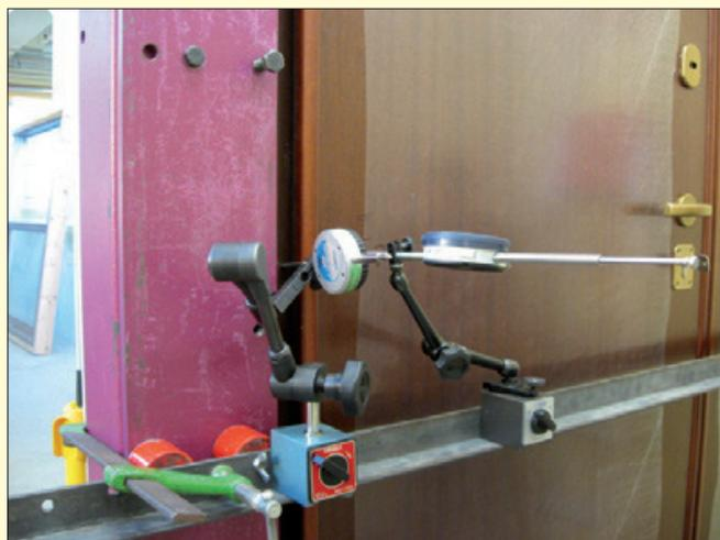
Antieffrazione: prova sotto carico statico.
